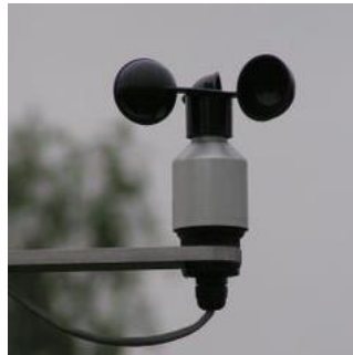
anemometr – měří rychlost a směr větru
