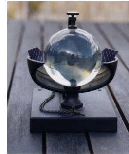
heliograf – měří délku denního svitu
